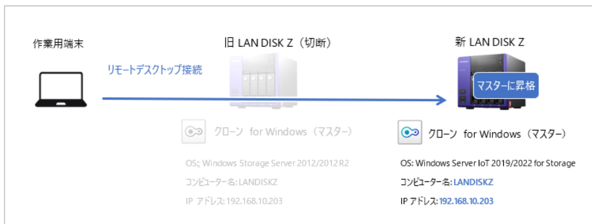
図 2-2 スレーブをマスターに昇格することで、新 NAS デバイスへの移行が完了
