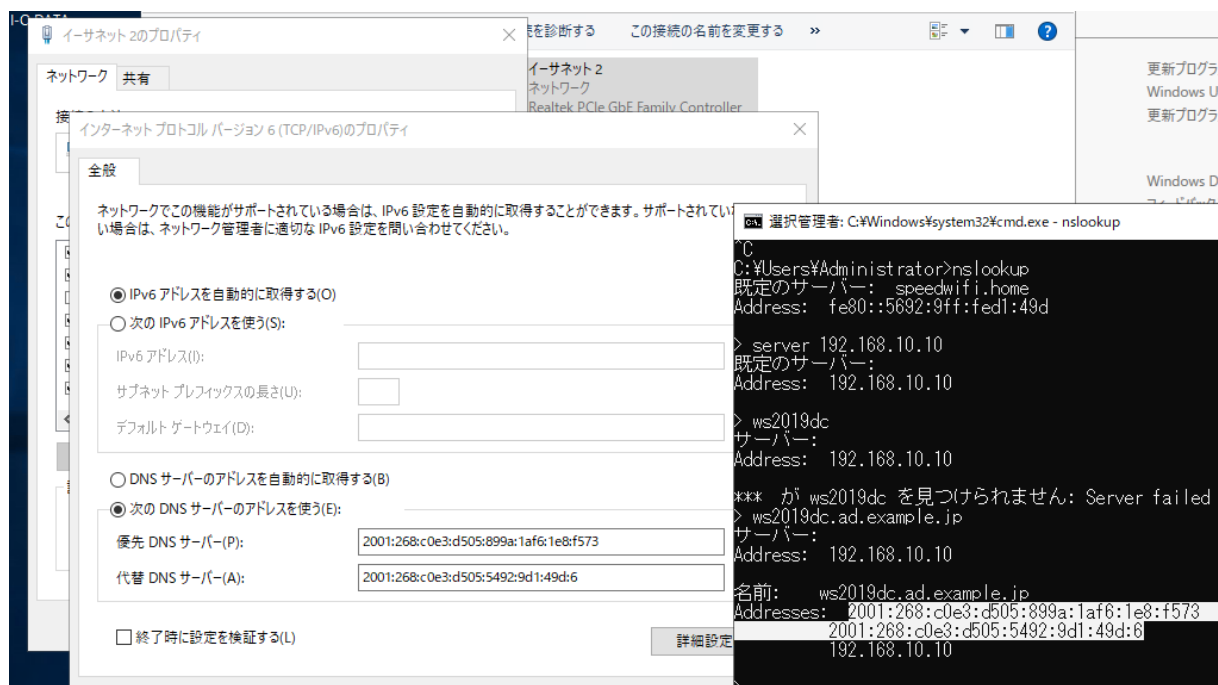
画面：ドメインコントローラーの IPv6 アドレスを調べ、DNS サーバーの参照先に設定する
