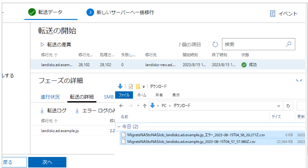
画面 2-30 転送結果とログを確認する（この例ではエラーログが 0KB であるため、エラーなし）
