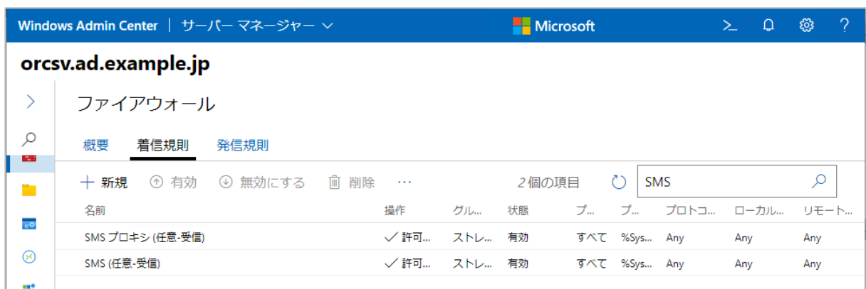
画面 2-8 ストレージ移行サービスのファイアウォール規則が有効になっていることを確認する
