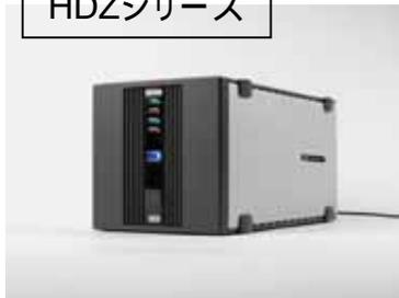
従来のHDで採用していた、電源連動機能・出荷時フォーマット済みは踏襲し、さらにユーティリティソフトをバンドルし、搭載した4台のドライブのスタンバイ突入時間の設定をコントロールできるようにしました。これにより、アクセス頻度の低いドライブをスタンバイ設定とすることで、消費電力の低減を図ることができます。また、ファンコントロール回路も搭載しており、筐体内温度が低い場合は、ファンが動作せず、省電力・静音に貢献しました。
