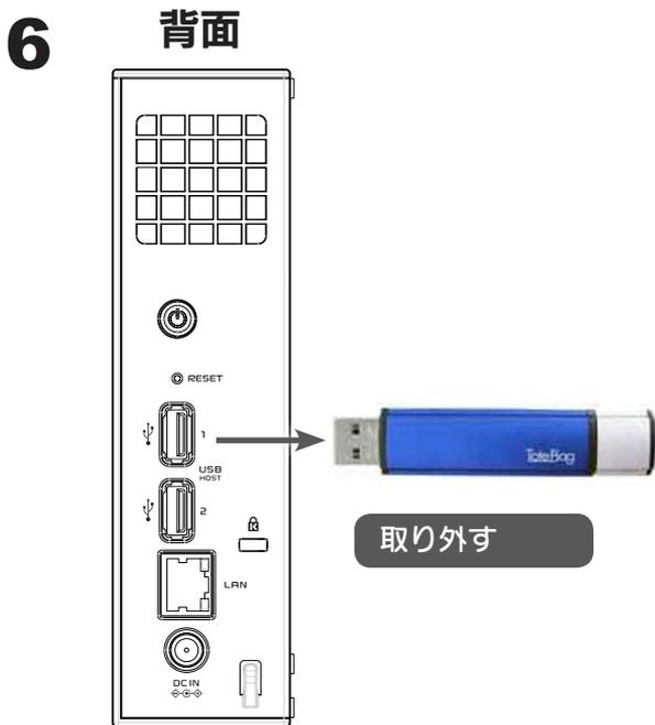
USB メモリーを接続すると、本製品の電源が自動的に切れます。STATUS ランプが消灯するまで、しばらくお待ちください。本製品の電源が切れたら、USB メモリーを取り外します。
