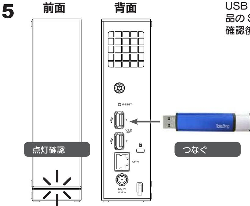
USB メモリーをパソコンから取り外し、本製品の STATUS ランプが緑点灯していることを確認後、背面の USB ポート 1 につなぎます。
