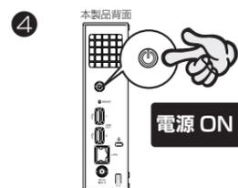
本製品背面の電源ボタンを押します。「ピポ」と音が鳴りSTATUSランプが緑色に約3分点滅します。完全に起動するまでお待ちください。※「ピー」と音がなり、STATUSランプが緑点灯となれば起動完了です。
