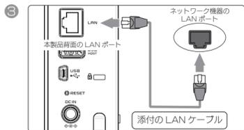
必ず、LANケーブルを先に接続してください。LANケーブルを接続する前に本製品の電源を入れます、正しくネットワークに参加できなくなります。
