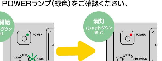
③ シャットダウンが終了すると、自動的に電源が切れ、POWERランプが赤く点灯します。
