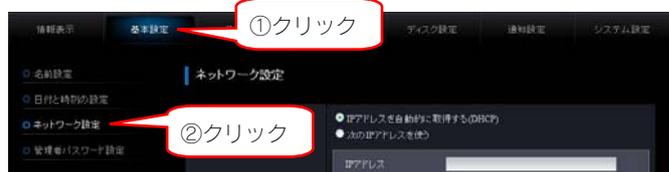
6 [LAN]の設定項目で、画面にしたがい IP アドレスおよびサブネットマスクを設定します。IP アドレスおよびサブネットマスクには、ドメインコントローラーにアクセス可能な適切な値を設定してください。
