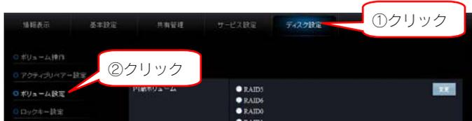
2 [内蔵ボリューム]で変更する RAID モードにチェック後、[変更]ボタンをクリックします。
