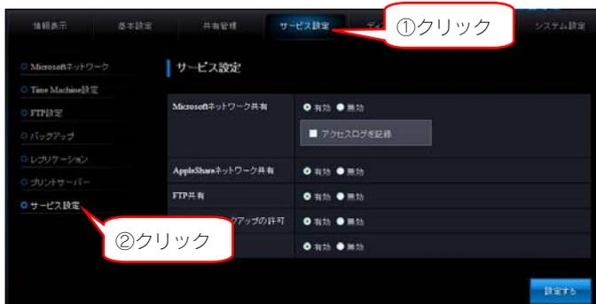
2 使用量制限の[有効]を選択し、[設定する]ボタンをクリックします。
