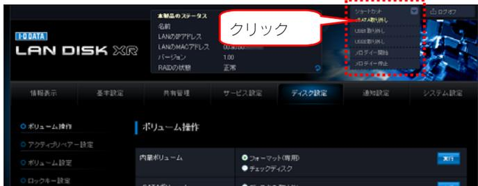
2 取り外すハードディスクを確認後、[デバイスを取り外す]ボタンをクリックします。
