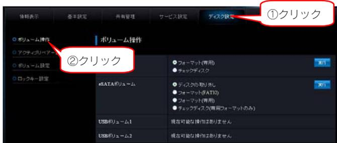
2 取り外すボリューム欄の [ディスクの取り外し] を選択後、[実行] ボタンをクリックします。
