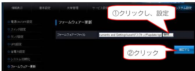
3 内容を確認し、[更新する]ボタンをクリックします。本製品の[STATUS]ランプが点滅を開始します。更新後、本製品が再起動します。
