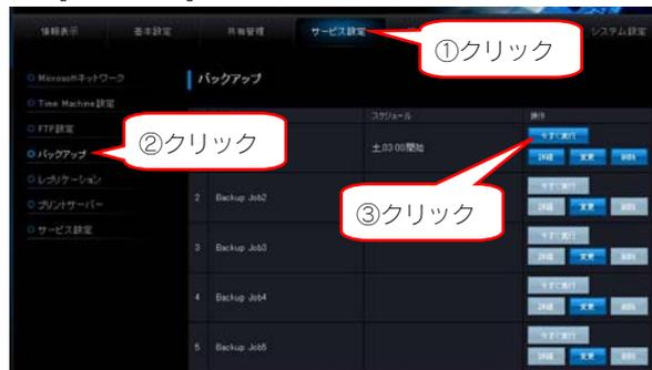
バックアップ中は、[STATUS]ランプが緑点滅になります。バックアップが完了すると本製品のブザーが「ピッピッピッ」と鳴り、[STATUS]ランプが緑点灯に変わります。
