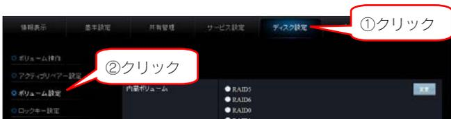
2 [内蔵ボリューム]の動作モードの選択で「暗号化 RAID5」または、「暗号化 RAID6」のいずれかにチェックした後、[変更] ボタンをクリックします。
