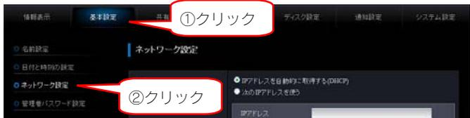
7 [LAN]の設定項目で、画面にしたがった IP アドレスおよびサブネットマスクを設定します。IP アドレスおよびサブネットマスクには、ドメインコントローラーにアクセス可能な適切な値を設定してください。
