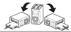
5 取り出したHDDの取手金具のネジ(2本)をドライバーで取り外し、 交換用HDDに取り付けます。
