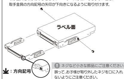
6 交換用HDDの取手金具の方向記号の矢印が下向きになるよう注意し、 本製品に差し込みます。
