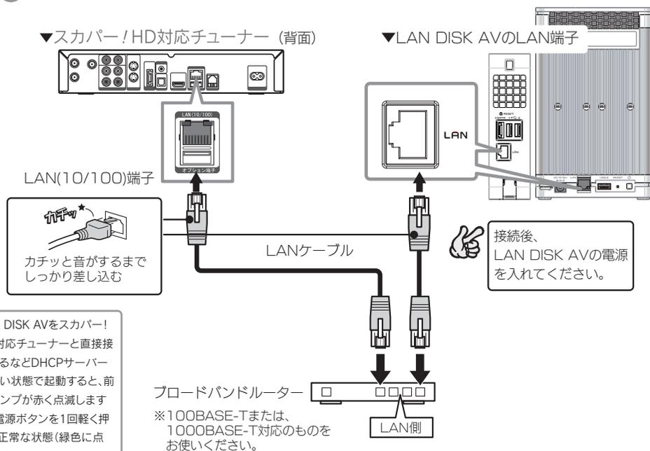
**参考** LAN DISK AVをスカパー！HD対応チューナーと直接接続するなどDHCPサーバーがない状態で起動すると、前面ランプが赤く点滅しますが、電源ボタンを1回軽く押すと正常な状態(緑色に点灯)に戻ります。
