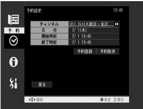
[チャンネル]：左右ボタンで目的のチャンネルを選択します。
