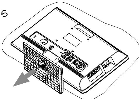
2 台座を外した所にあるネジ 2 個所を外し、台座軸を外します。
