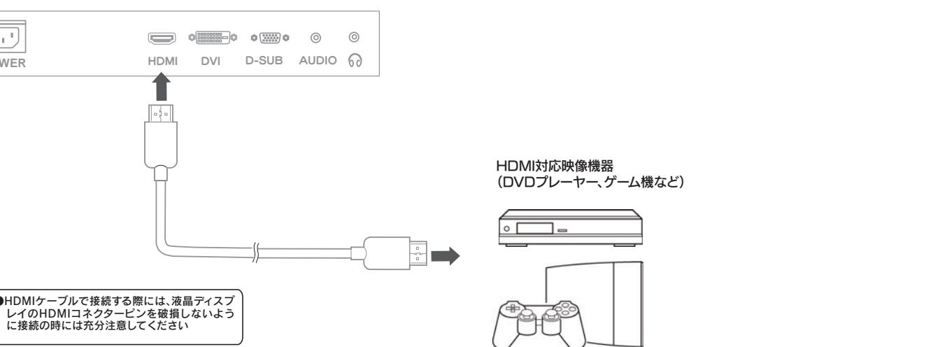
●HDMIケーブルで接続する際には、液晶ディスプレイのHDMIコネクターピンを破損しないよう接続の際には充分注意してください。
