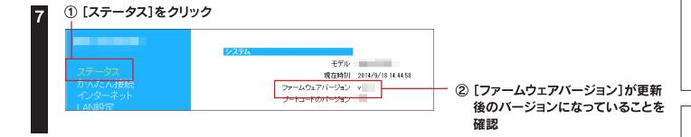
以上で、ファームウェアの更新は完了です。手順2で接続したLANケーブルを外し、元の設置状態に戻します。
