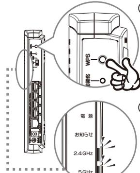
②2.4GHzランプと5GHzランプが同時に点滅したら、ボタンを離す
