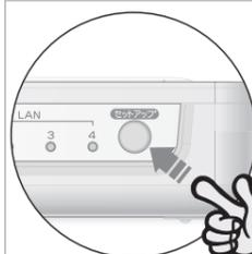
左のイラストが表示された場合、本製品の「セットアップ」ボタンを[ステータス]ランプが点滅するまで押します。(約3秒)その後、数分お待ちください。
