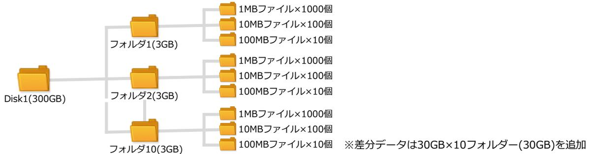
②(バックアップ元)HDL-XR4.0Wにテストデータを用意(300GB)してバックアップを実行。
