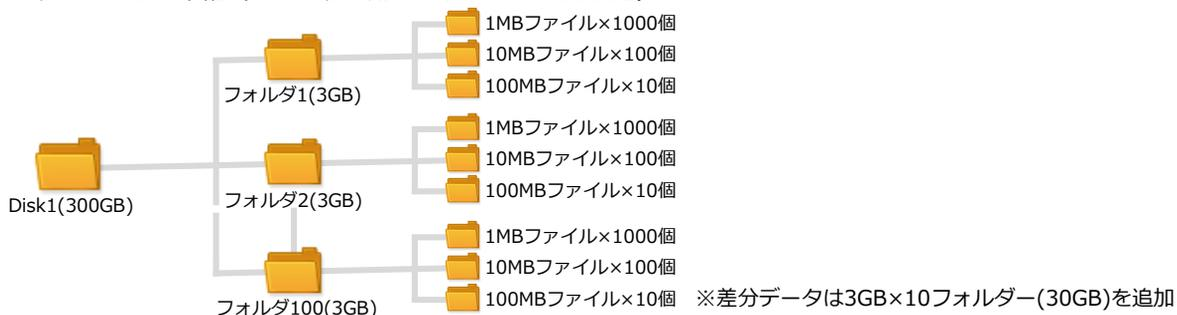
②(メイン機)HDL-XR4.0Wにテストデータを用意(300GB)してバックアップを実行
