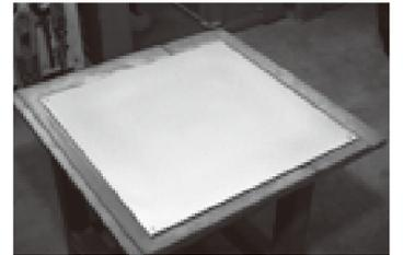
ヴァイブレーション加工が完了した状態のアルミ板。このアルミ板はその後、アルマイト処理が施され、さらにエッジ部にダイヤモンドカットが施され、やっと完成となる。
