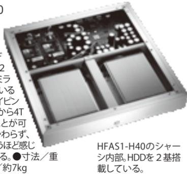
HFAS1-H40のシャーシ内部、HDDを2基搭載している。
