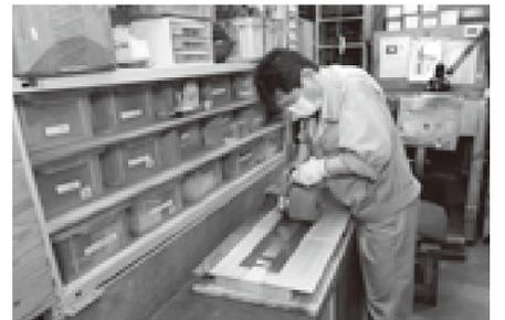
HFAS1シリーズのフロントパネルと両サイドパネルには、ヘアライン仕上げが施される。これも写真のようにすべて手作業で行なわれるが、その作業工程は、まずナイロンたわしの素材のようなものがロール状になっていて、そのロールをモーターに取り付け、アルミパネルの表面に圧着させながら繊細なヘアラインを刻んでいく。
