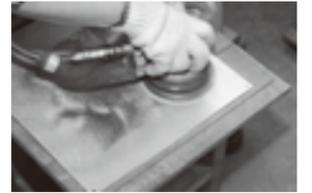
熟練の職人がオービタルサンダー(仕上げサンダー)を使ってヴァイブレーション仕上げを行なっている様子。職人が絶妙な力加減でオービタルサンダーの丸いサンドペーパー面をアルミ板に押し当てながら研磨していくと、5~6分でアルミ板全体に和紙を絞ったような淡く美しい波模様が浮かび上がる。そして、もっとキメの細かいオービタルサンダーで、さらに研磨して仕上げる。
