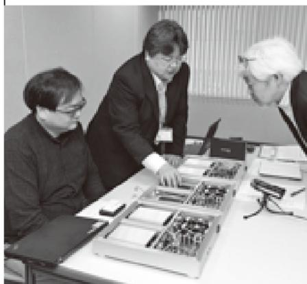
ファイダータHFAS1-H40の試作機(奥)と、製品版(手前、4TB HDD)、およびHFAS1-S10(1TB SSD、中央)の天板を空けて、内部を見せてもらっているところ。開発に携わった開口氏(中央)と北村氏(左)に、内部の仕様の変化や変更されたパーツ、さらにはメイン基板とストレージ部を分けるT字フレームの接合の様子など、詳しく教えていただく。T字フレームの取付け位置が開発途中で変わったことも、このとき分かった。
