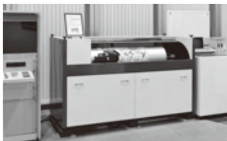
アイ・オー・データ機器の本社ビル1階ホールに展示されている、紋紙用スキャナー(カラー画像自動読取装置)。70年代に作られたという本機は、社内保管の個体ではなく、35年にわたって実際に使われていたものを、最近同社で引き取ったものという。しかし状態はひどい。織物はドラムに貼り付けられてスキャンされ、フロッピーに保存される仕組みだが、ドラム式なのはフラットベッド式ではスペースを取りすぎるからだそう。
