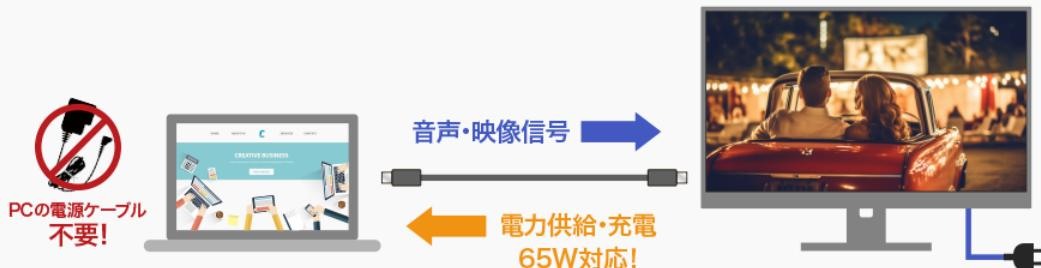
※USB Type-Cでの映像・音声入力は、ご使用される機器にDisplayPort Alt Mode対応のUSB Type-Cポートが必要です。
