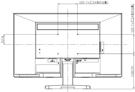
く注記> 1.>指示なき寸法公差は±2.0以下とする。 2.)中心線にActive Areaの中心を示す。 3.)指示なき寸法は中心線に対して対称とする。 4.)本図は参考資料に付予告無く変更する事がある。
