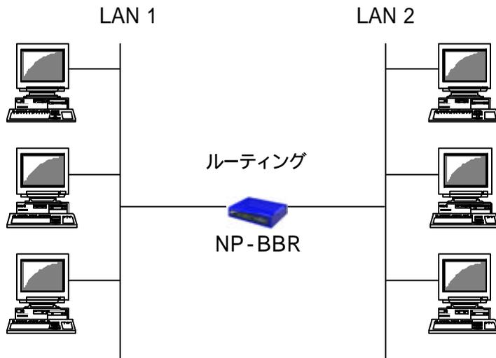
本装置はセグメント数の少ないネットワークで異なる LAN どうしを接続するのに向いています。また、あらかじめ設定しておいて基幹ネットワークの経路に障害が発生したときなど緊急時のバックアップ用として利用することもできます。
