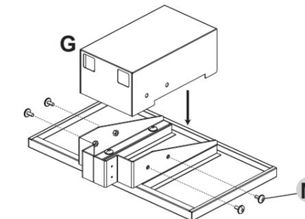
**5** 手順4で組み上げたものを支柱下に(M)六角穴付ボルトで取り付ける
