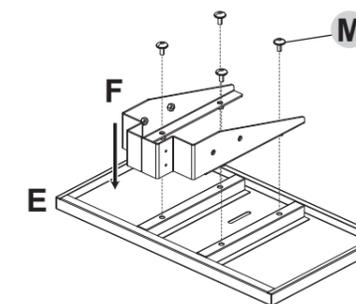
**4** (G)収納箱を(M)六角穴付ボルトで取り付ける
