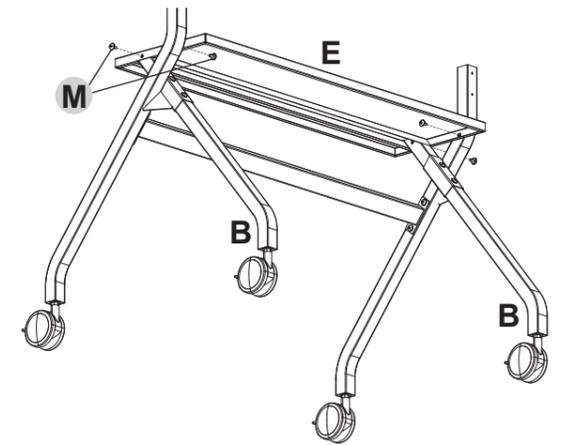
**5** (C)支柱を(M)六角穴付ボルトで仮固定する
