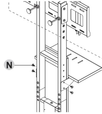
**15** (K) ケーブルフックを支柱上に (N) 六角穴付ボルト : M6 で取り付ける
