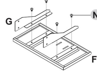
**14** 手順 13 で組み上げたものを支柱に (N) 六角穴付ボルト : M6 で取り付ける
