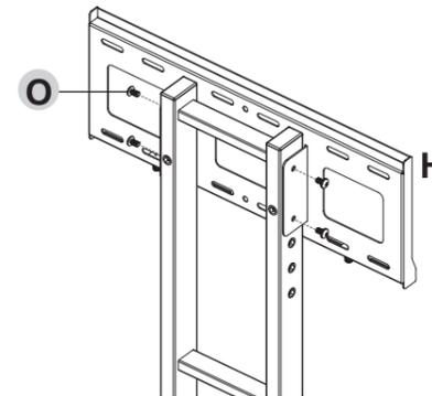
2 (D)支柱連結金具を(N)六角穴付ボルト:M6で仮固定する
