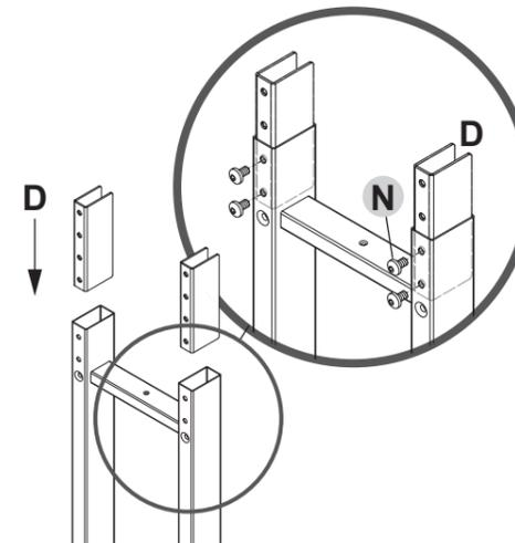
5 (J)STB収納箱を本体裏側から(N)六角穴付ボルト:M6で取り付ける
