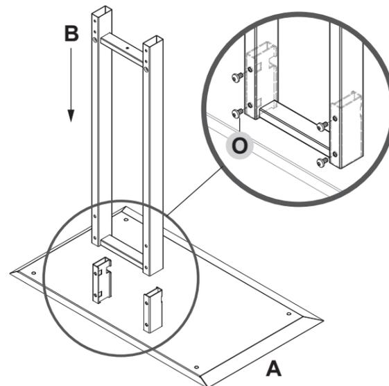
4 (H)マウントフレームを支柱に(O)六角穴付ボルト:M8で取り付ける
