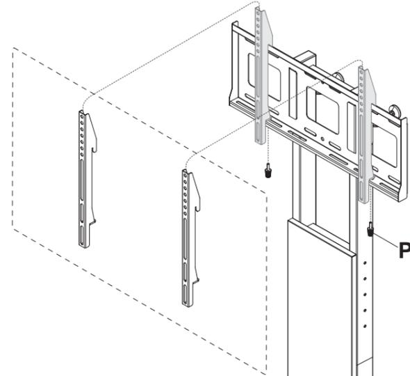
**13** (F) 棚板に (G) 棚板取付金具【L/R 各 1 個】を (N) 六角穴付ボルト : M6 で取り付ける
