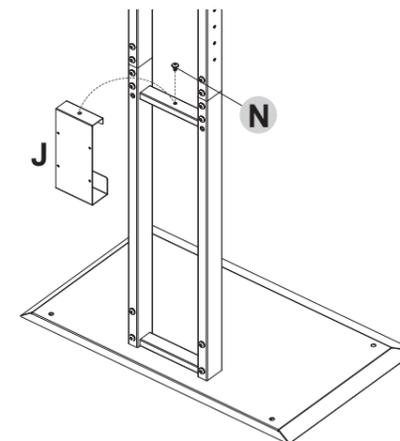
3 (C)支柱上を(N)六角穴付ボルト:M6で取り付ける
