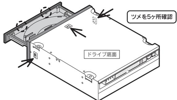
**4** トレイカバーを取り外します。手順3で確認したトレイカバーの2ヶ所のツメを押し上げながら、上にスライドさせて取り外します。
