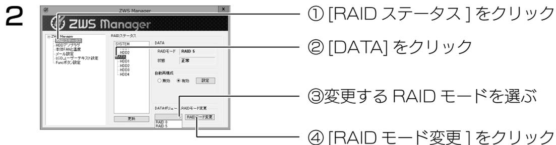
選択した [RAID モード] への変更を開始します。([ 状態 ] が再構築中になります。)
