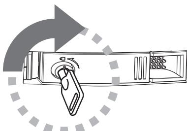
添付のロックキーを [ カートリッジ固定ロック ] に合わせ横向きに挿し、時計回りにまわして、[UNLOCK] にする
