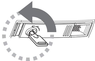
添付のロックキーを [ カートリッジ固定ロック ] に合わせ縦向きに挿し、反時計回りにまわして、[LOCK] にする
