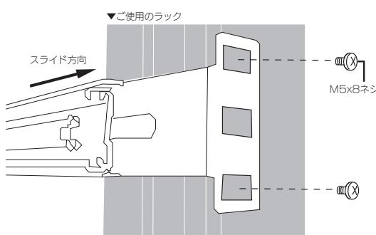
外側レールをラック（クリップナット）に取り付ける（合計8か所）
