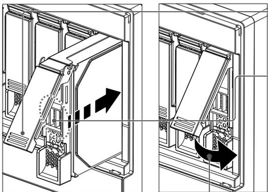
①取り付けるカートリッジの着脱レバーを固定されるまで上げる
