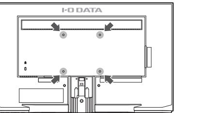
※ドライバーを使ってネジを締付けてください。スパナなど他の工具で締付けると、ネジ穴が破損する恐れがあります。
