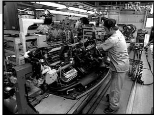
組み立て工程では、エンジン、タイヤ、シートやハンドルなど、いろいろな部品を組みつけていきます。自動車を組み立てる作業の8割は、人が行っています。1台ごとに組み付ける部品が違うこともあるので、常にモニターをチェックしながら注意深く作業を行います。
