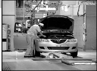
完成検査では、ブレーキテストや排出ガステストなど実際に車を走らせながら、検査が行われます。検査する箇所は約2000項目あります。ライトがつかか、ブレーキのきき具合はいいか、室内に水が入ってこないか、などを確認していきます。
