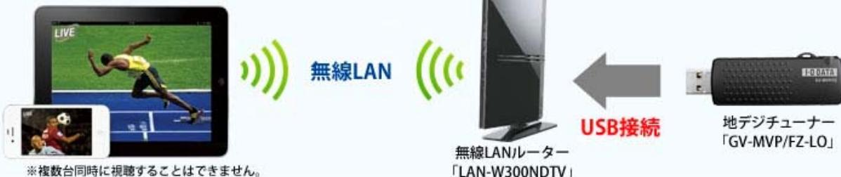
アイ・オー・データは、ネットワークデバイス共有機能(net.USB機能)を用いて無線LANルーターにパソコン用地デジチューナーをUSB接続することにより、Wi-Fi経由で地デジTVを見られるソリューションを市場に投入しています。これによって、テレビアンテナ線のない部屋でも、iPadなどを利用して家の中の好きな場所で手軽にテレビを視聴することができます。今回、同じくネットワークデバイス共有機能(USB機器管理ツール)を持つロジテック社製無線LANルーターとコラボレーションを行うことにより、本ソリューションを広く市場に提供してまいります。
